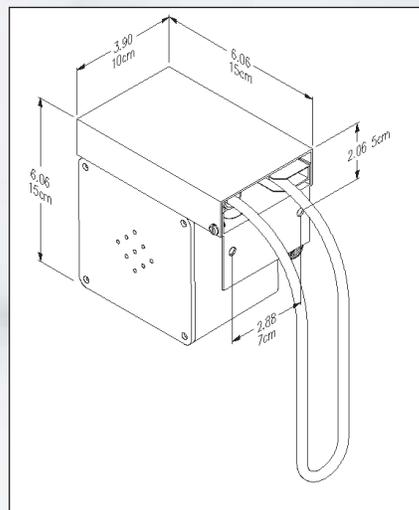
Der TubeTastic Schlauchskimmer wird vor allem bei CNC-Bearbeitungszentren eingesetzt, wo die Kühlflüssigkeitstanks oft nur schlecht zugänglich sind.
